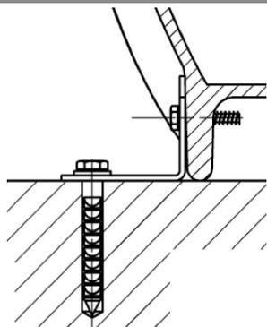
Посредством прилагающегося крепежного материала зафиксировать установку на полу (рис. 8).
