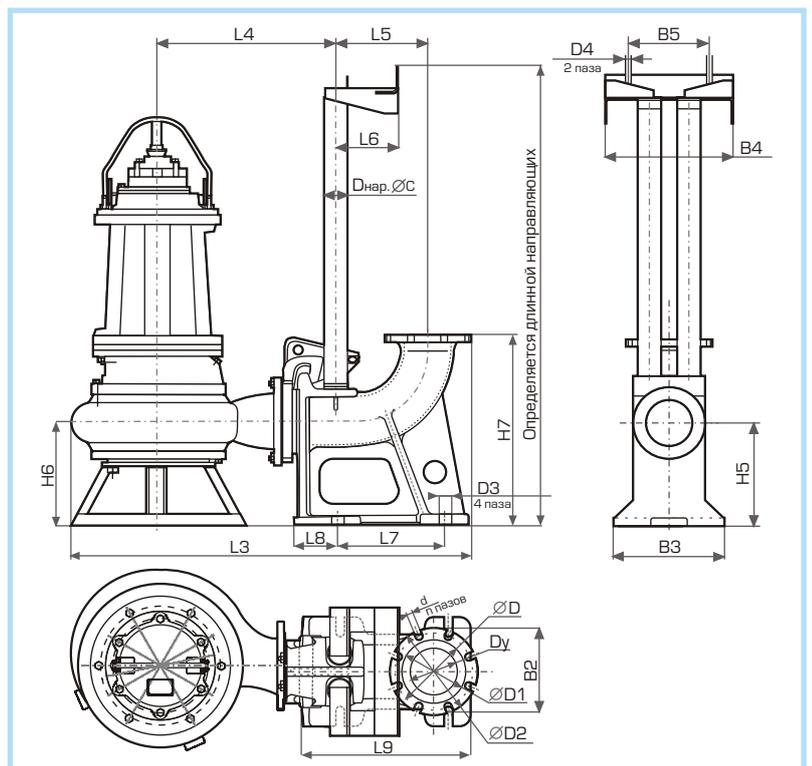
Габаритные размеры погружных насосов серии Иртыш ПФ
