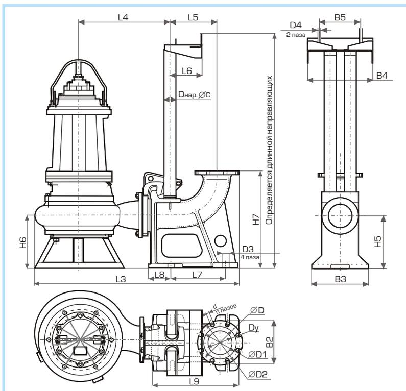
Габаритные размеры погружных насосов серии Иртыш ПФ
