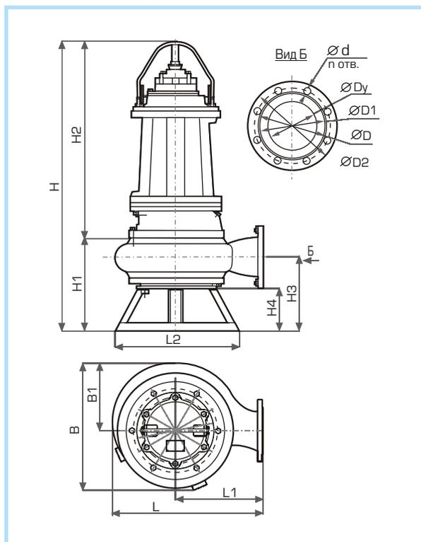
Габаритные размеры погружных насосов серии Иртыш ПФ
