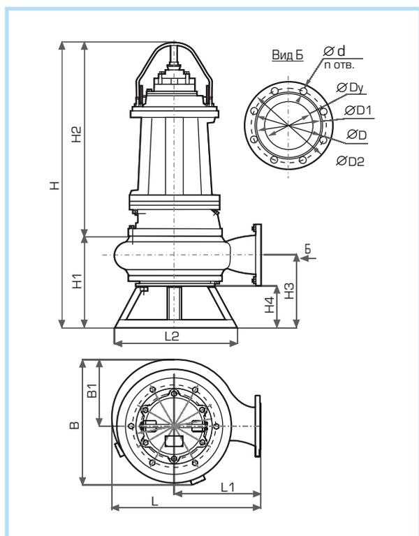
Габаритные размеры погружных насосов серии Иртыш ПФ
