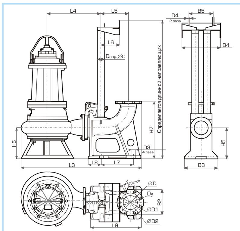
Габаритные размеры погружных насосов серии Иртыш ПФ
