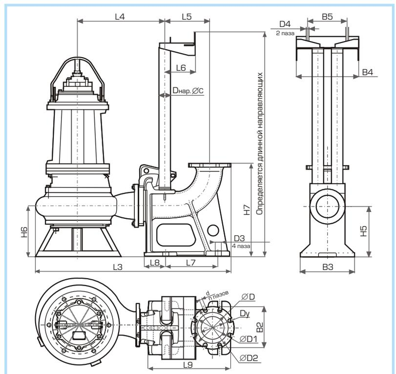
Габаритные размеры погружных насосов серии Иртыш ПФ
