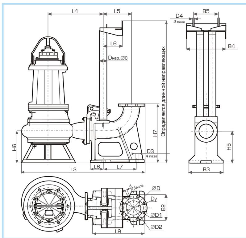
Габаритные размеры погружных насосов серии Иртыш ПФ
